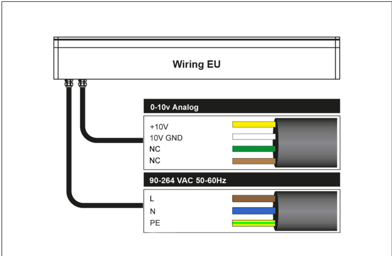
Der Leuchtenanschluss erfolgt über eine bauseitige Verbindungsmuffe außerhalb des Einbaugeschüsses. Anschlussleitung mit Erdkabel dicht verbinden. Für das Herausnehmen der Leuchte ist im Einbaugeschüss eine Leitungslänge von 0,3 m vorzusehen. Leitungen nur geschützt (z.B.: geeignete Installationsrohre) im Erdreich verlegen. Leuchtengeschüss in das Einbaugeschüss setzen. Verschluss Schrauben festziehen.
