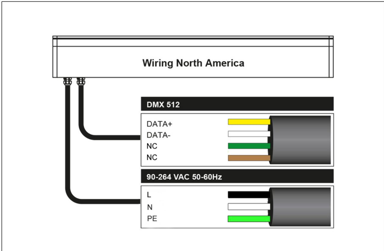
Der Leuchtenanschluss erfolgt über eine bauseitige Verbindungsmuffe außerhalb des Einbaugeschäuses. Anschlussleitung mit Erdkabel dicht verbinden. Für das Herausnehmen der Leuchte ist im Einbaugeschäuser eine Leitungslänge von 0,3 m vorzusehen. Leitungen nur geschützt (z.B.: geeignete Installationsrohre) im Erdreich verlegen. Leuchtengeschäuser in das Einbaugeschäuser setzen. Verschluss Schrauben festziehen.
